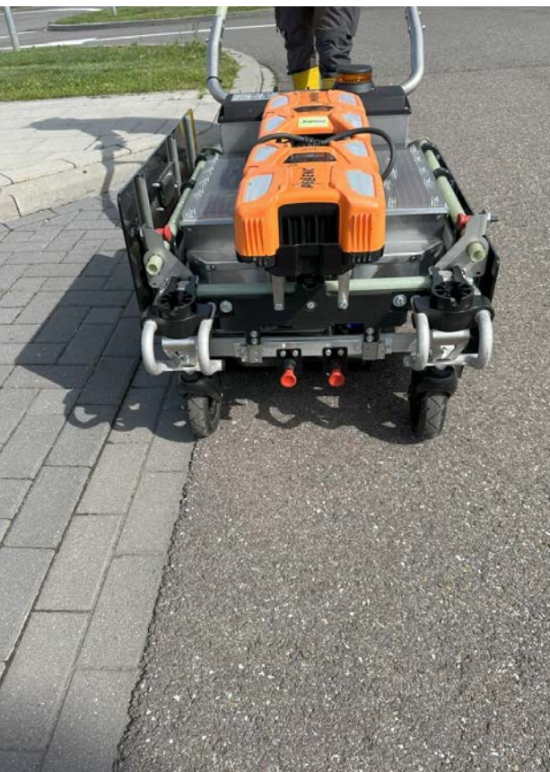
De eWeeding Roller lijkt op een grasmachine maar heeft roterende, elektrisch geladen lamellen. Slim, stil en CO 2 -neutraal.
